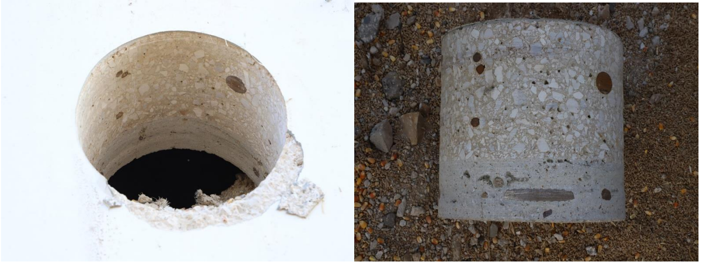
Figure 5. أسطوانات وثقوب التفريغ حسب توصيات تقرير خطيب وعلمي.
